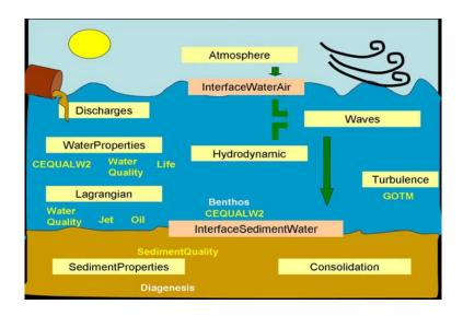
Figura 5 – Estrutura de Módulos do MOHID Water
