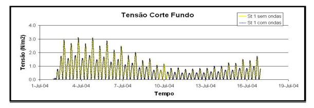
Figura 53 – Tensão de Corte no Fundo em função do tempo para a estação 1 durante o mês de Julho de 2004.
