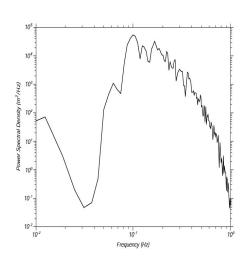
Figura 4 – Espectro de Onda: Densidade espectral (m²/Hz) em função da frequência (Hz). Fonte: Stewart (2005).
