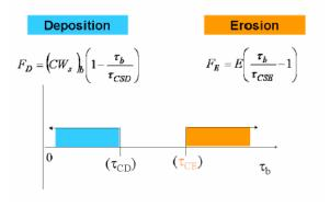
Figura 61 - Algoritmo de erosão e deposição
