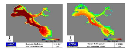
Figura 11 – Alturas de onda para dois instantes diferentes. A escala de cores é diferente nas duas figuras – 0-40 cm na primeira e 0-30cm na segunda.
