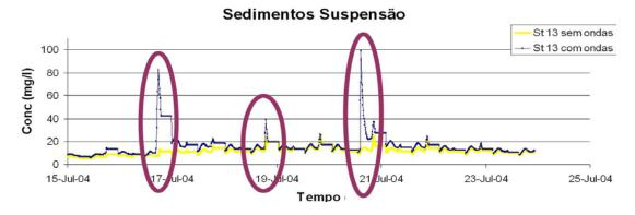
Figura 27 – Concentração de sedimentos em suspensão em função do tempo para a estação 13.
