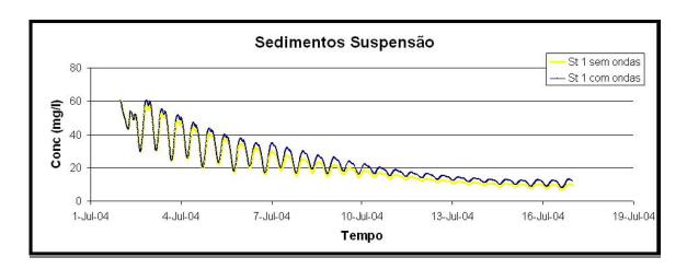
Figura 55 – Concentração de sedimentos em suspensão em função do tempo para a estação 1 no mês de Julho de 2004
