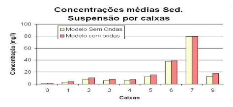
Figura 33 – Comparação entre os resultados do modelo com ondas e sem ondas para os sedimentos em suspensão.
