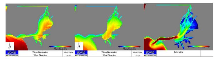
Figura 42 – Altura de onda com vento de Noroeste (à esquerda) e com vento de Nordeste (no meio). À direita, a batimetria do estuário.
