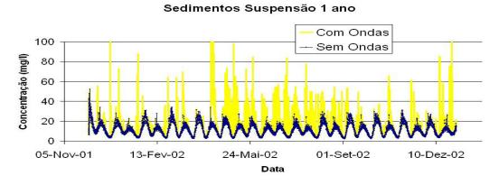
Figura 34 – Evolução temporal da concentração de sedimentos em suspensão para a estação 13 com o modelo com ondas e sem ondas.
