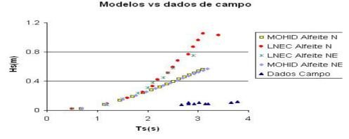
Figura 15 – Relação Altura de Onda – Período de Onda na simulação MOHID para a zona de Alfeite. Fonte dados LNEC: Freire (2003).
