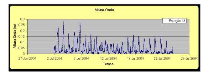
Figura 44 – Altura de Onda em função do tempo para a estação 13.
