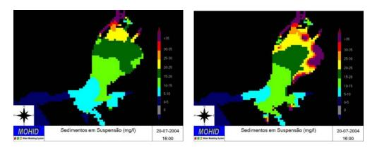
Figura 36 – Comparação entre os resultados do modelo sem ondas (à esquerda) e com ondas (à direita) para o dia 20/7/04 às 16h (próximo da hora da captação da imagem de satélite – entre as 14h e 15h). A legenda por classes é igual para as 2 imagens e para a Figura 35: de 0 a 35 mg/l, com classes de 5 em 5mg/l.
