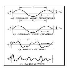
Figura 3 – Tipos de ondas Fonte: CEM (2002)
