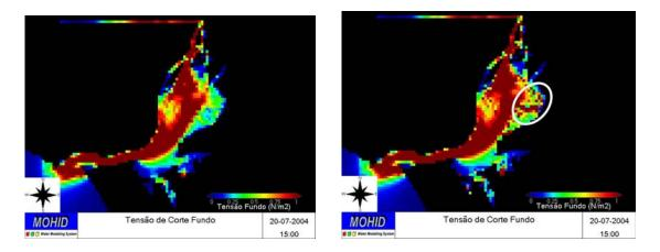
Figura 19 – Distribuição de tensões de corte no fundo para o instante das 15h do dia 20/7/2004. À esquerda a simulação sem ondas e à direita com ondas. A escala de cores está referida do zero ao 1 N/m²
