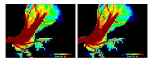
Figura 39 – Comparação entre a batimetria com células 500x500m (à esquerda) e a batimetria 200x200m (à direita).
