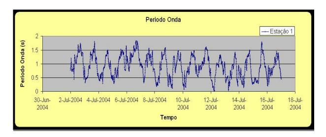
Figura 47 – Período de Onda em função do tempo para a estação 1.
