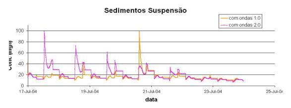
Figura 29 – Evolução das concentrações de sedimentos em suspensão na estação 13 para a simulação com ondas com 2 parâmetros diferentes na altura de onda (1.0 e 2.0).
