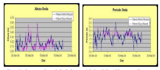
Figura 12 – Comparação dos resultados de altura e período de onda do modelo com as medições na Bóia na localização Mussel.
