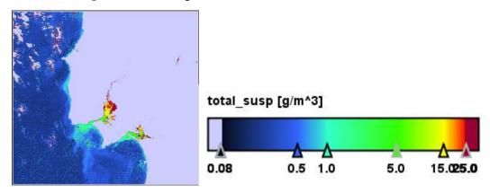
Figura 1 – Imagem de satélite do sensor MERIS para parte da costa ocidental portuguesa. É representada a distribuição de sedimentos em suspensão. Fonte: ESA.
