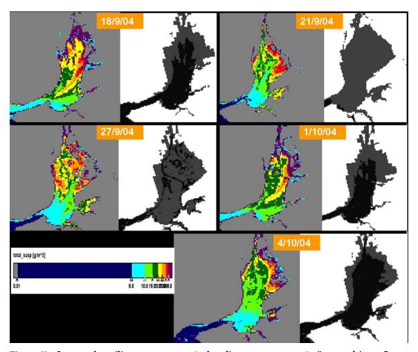
Figura 60 – Imagens de satélite com concentração de sedimentos em suspensão (à esquerda) para 5 instantes de 2004. A escala é classificada (de 5 em 5 mg/l) até 35mg/l. A imagem de 20 de Julho é apresentada no relatório.
