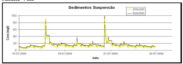
Figura 62 – Comparação de resultados de sedimentos em suspensão para a estação 13 no mês de Julho de 2004, utilizando duas batimetrias (a original com malha 500x500m e a nova com malha 200x200m).
