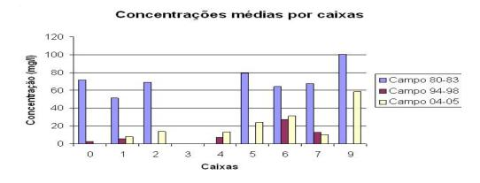
Figura 31 – Comparação entre valores médios das concentrações de sedimentos em suspensão para as diferentes caixas para os dados de campo.
