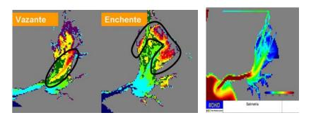
Figura 38 – Distribuições típicas dos sedimentos em suspensão para as imagens de satélite. Batimetria à direita.
