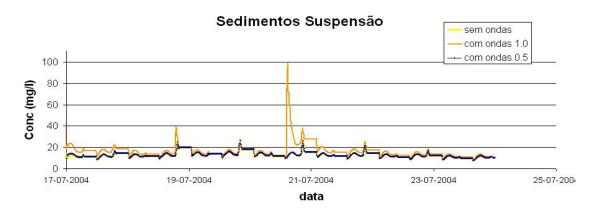
Figura 28 – Evolução das concentrações de sedimentos em suspensão na estação 13 para a simulação sem ondas e simulação com ondas com 2 parâmetros diferentes na altura de onda (0.5 e 1.0).
