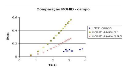
Figura 16 – Comparação de resultados para diferentes parâmetros de altura de onda com os dados de campo.
