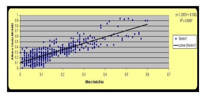
Figura 50 – Correlação entre altura de onda calculada pelo MOHID e a altura medida na bóia.
