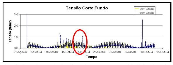
Figura 57 – Tensão de corte no fundo em função do tempo para a estação 13 de 2 de Setembro a 12 de Outubro de 2004.
