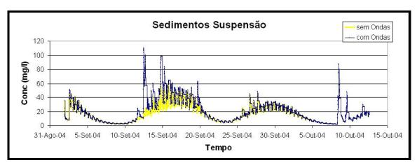
Figura 59 – Concentração de sedimentos em suspensão em função do tempo para a estação 13 de 2 de Setembro a 12 de Outubro de 2004.
