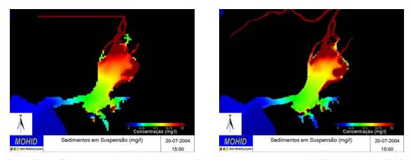
Figura 23a – Comparação de resultados de sedimentos em suspensão no dia 20 de Julho de 2004, utilizando duas batimetrias (a original com malha 500x500m à esquerda e a nova com malha 200x200m à direita).
