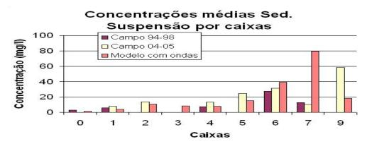
Figura 32 – Comparação entre os resultados do modelo e os dados de campo para os sedimentos em suspensão por caixas.
