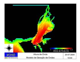
Figura 18 – Distribuição de alturas de onda para as 15h do dia 20/7/2004. A escala de cores está referida do zero aos 30cm. Instante próximo da preia-mar.
