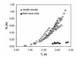
Figura 14 – Comparação de resultados do modelo SMB (LNEC) e de dados de campo. Altura de onda versus Período de onda. Fonte: (Freire, 1999)
