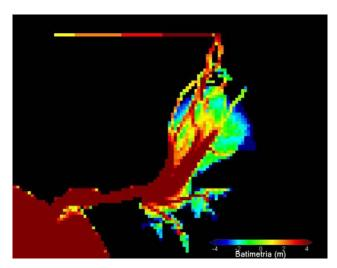
Figura 17 – Batimetria utilizada para o estudo. A azul as zonas de menor profundidade.
