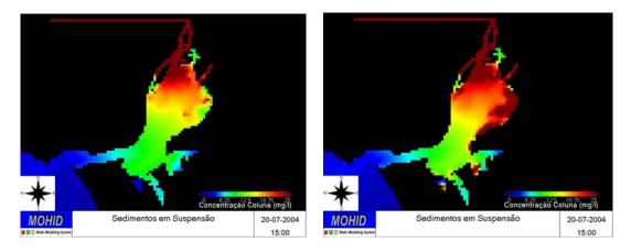
Figura 20 – Distribuição de concentrações em suspensão para o instante das 15h do dia 20/7/2004. À esquerda a simulação sem ondas e à direita com ondas. A escala de cores está referida do zero aos 25 mg/l.
