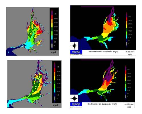
Figura 37 – Em cima, as concentrações de sedimentos em suspensão para o dia 21/9/04, em baixo para o dia 1/10/04. À esquerda estão as imagens de satélite e à direita os resultados do modelo.
