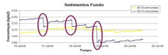
Figura 26 – Concentrações de sedimentos de fundo em função do tempo para a estação 13.
