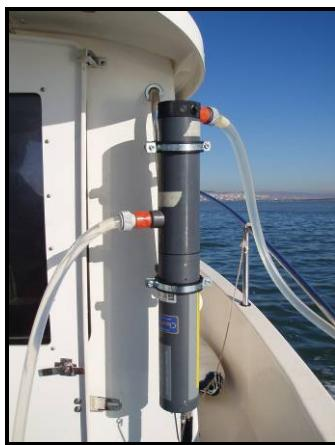
Figura 4. Sonda Multiparamétrica utilizada no sistema de mapeamento.
