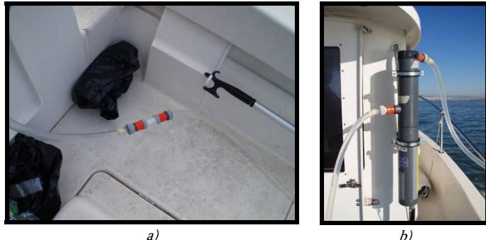
Figura 9. Componentes do sistema de mapeamento: a) medidor de cauda; b) sonda multiparamétrica.
