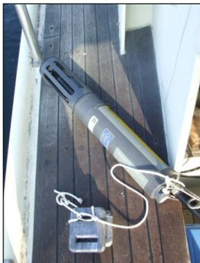
**Figura 2** - Sonda multiparamétrica (YSI 6600EDS), utilizada na campanha para registo dos parâmetros hidrológicos.
