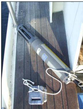
**Figura 2** - Sonda multiparamétrica (YSI 6600EDS), utilizada na campanha para registo dos parâmetros hidrológicos.
